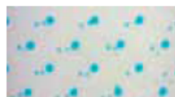
Regulärer Thermodruck bei Tintenstrahlverfahren
